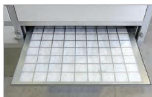
乾燥運転時にピット内からのごみを捕集し、天井フィルターの性能を維持するフィルターです。
