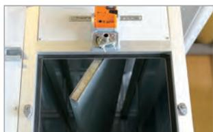
塗装運転時と乾燥運転時での空気の流れを入れ替えるためのダンパーです。
