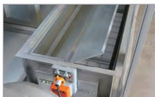
塗装運転と乾燥運転での空気の流れを入れ替えるためのダンパーです。
