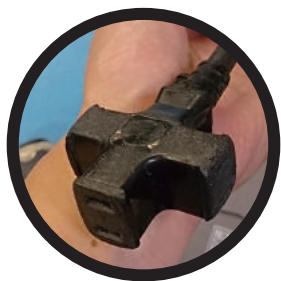
コンセントソケットの異常磨耗
